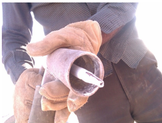
شکل ۴-۹: ساختار نازل مورد استفاده در کارخانه شیرین سفال شکل ۴-۱۰: دهانه مشعل و نازل مورد استفاده در کارخانه شیرین سفال
